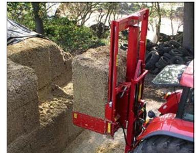
Siloblocksneider für Traktor und Lader, Entnahmhöhe bis 4m
