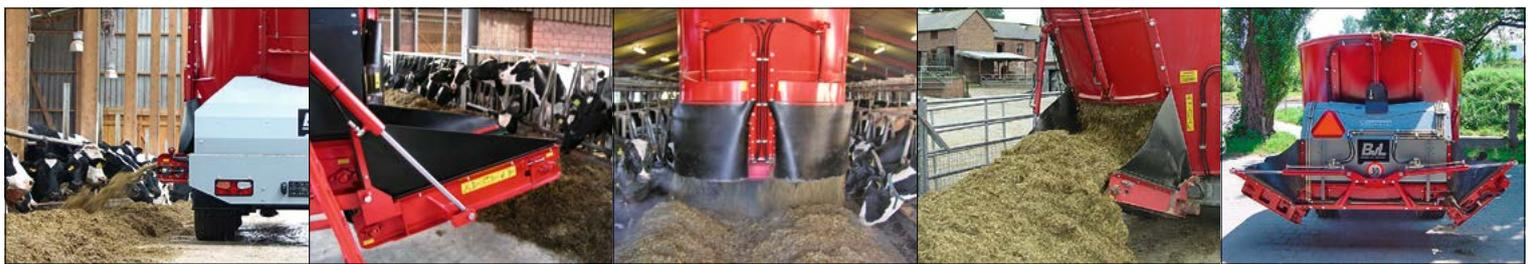
Diverse Austragemöglichkeiten: Querförderbänder hinten oder vorne, Seitenschieber, diverse Steigbänder
