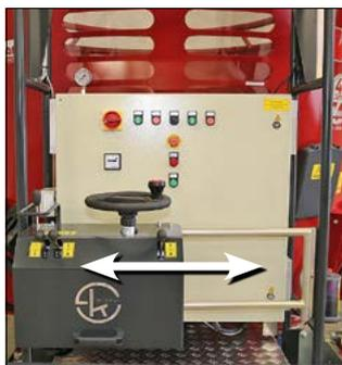
Bedienung links und rechts, verschiebbar mit Steuerrad
